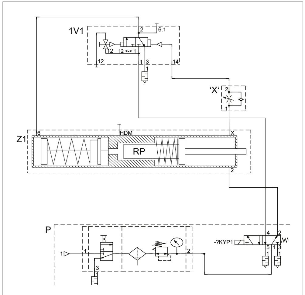
Fig. 10 Commande selon la procédure de pression dynamique pour le vérin amplificateur avec ressort mécanique
