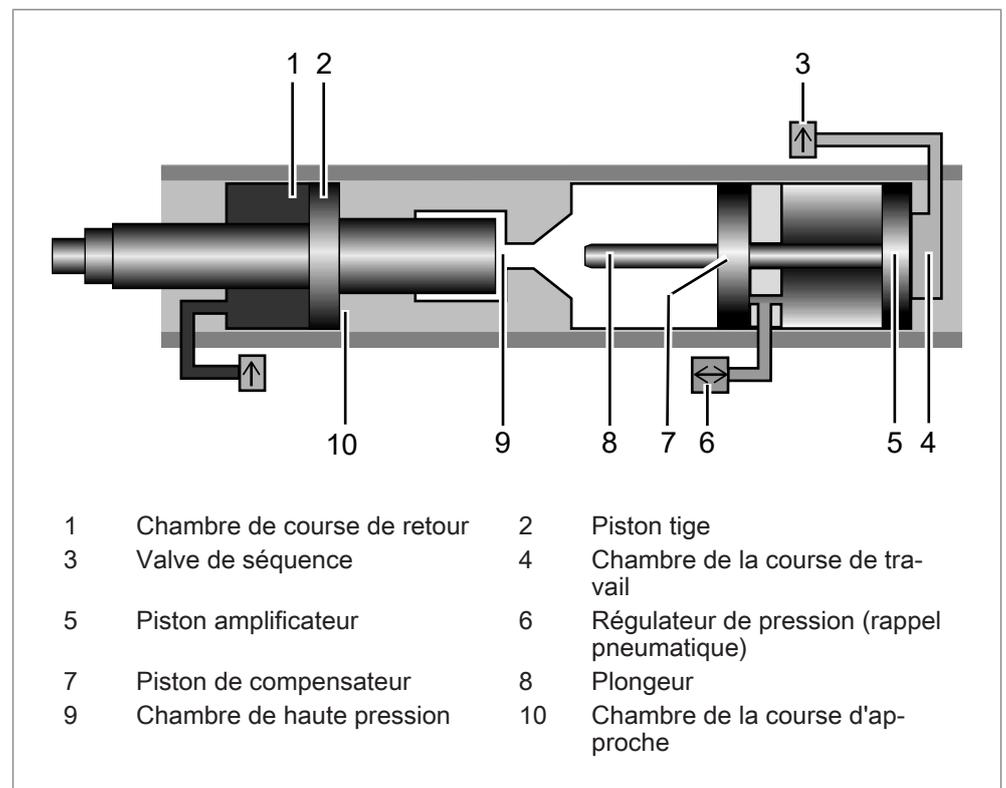
Fig. 6 Position de départ du vérin amplificateur sans course d'approche
