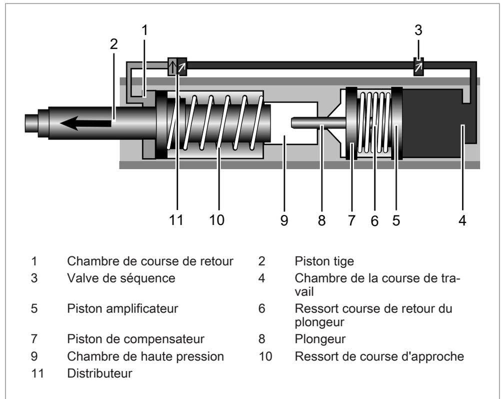
Fig. 4 Course de travail du vérin amplificateur avec ressort mécanique de course d'approche
