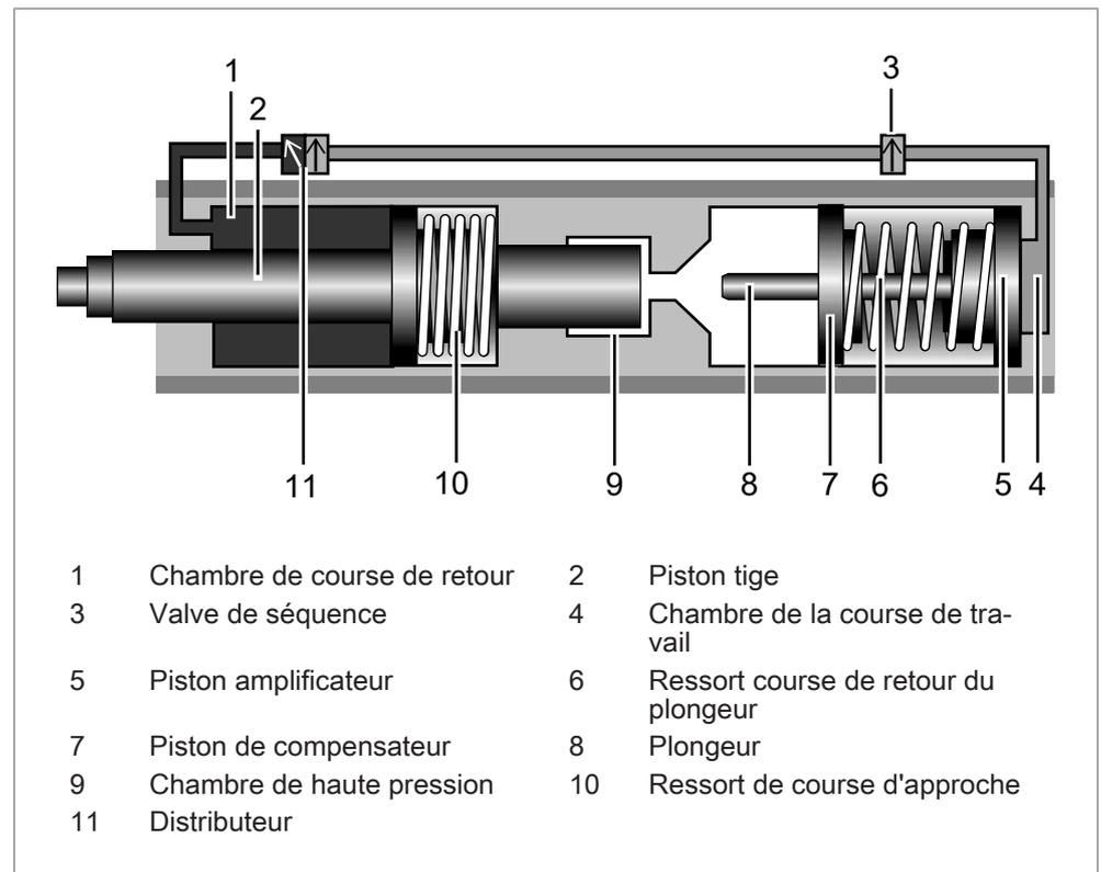
Fig. 2 Position de départ du vérin amplificateur avec ressort mécanique de course d'approche
