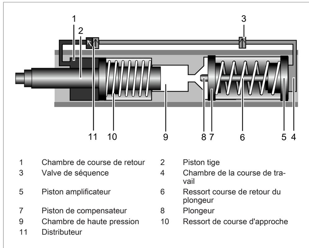
Fig. 5 Course de retour du vérin amplificateur avec ressort mécanique de course d'approche
