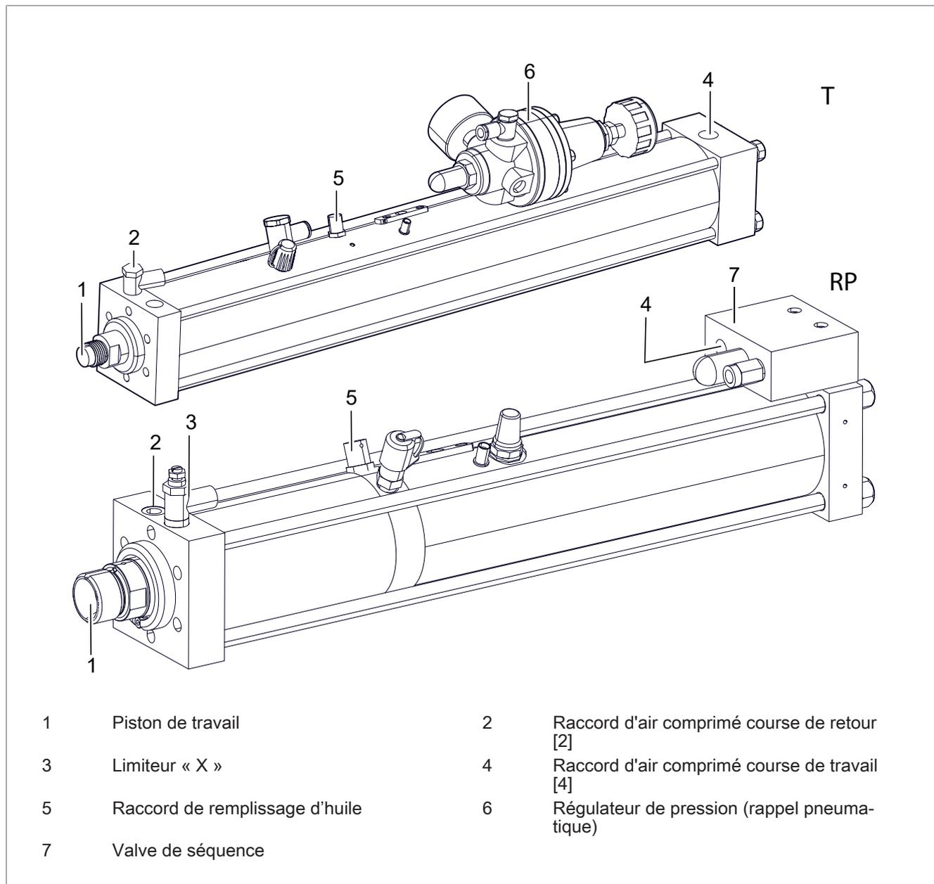
Fig. 1 Vue d'ensemble du modèle T, RP
