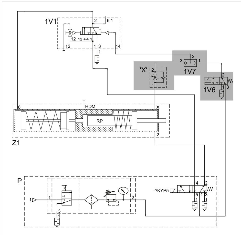
Fig. 17 Dispositif externe de validation de la course de travail (module ZKHF)
