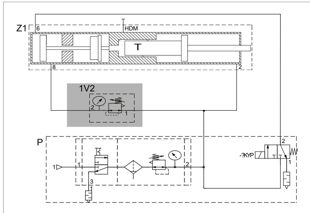
Fig. 11 Commande selon la procédure de pression dynamique pour le régulateur de pression du vérin amplificateur (rappel pneumatique)
