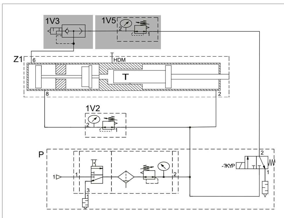
Fig. 13 Réglage de la pression dans le conduit de la course de travail (module ZDK)
