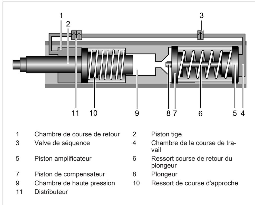
Fig. 3 Course d'approche du vérin amplificateur avec ressort mécanique de course d'approche
