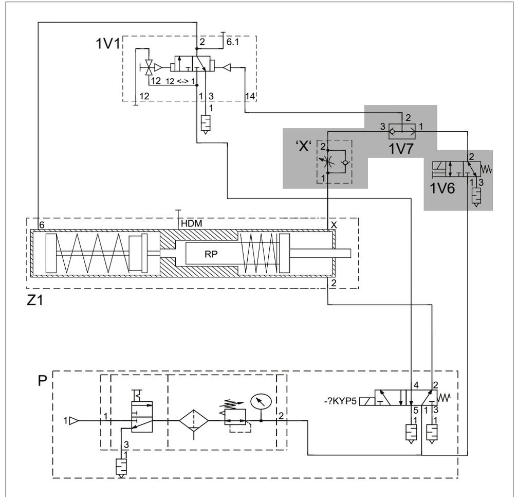
Fig. 16 Dispositif externe de désactivation de la course de travail (module ZKHD)
