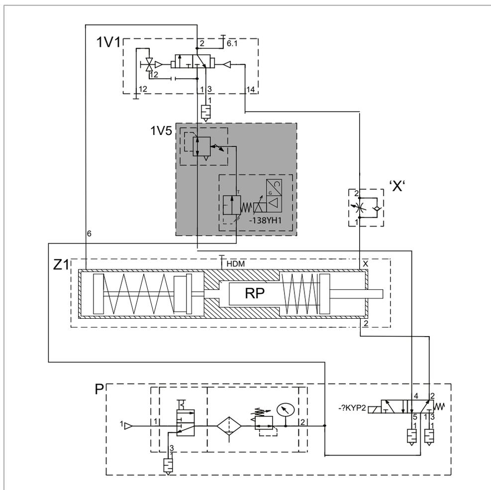
Fig. 14 Réglage de la pression dans le conduit de la course de travail avec valve de régulation de la pression proportionnelle
