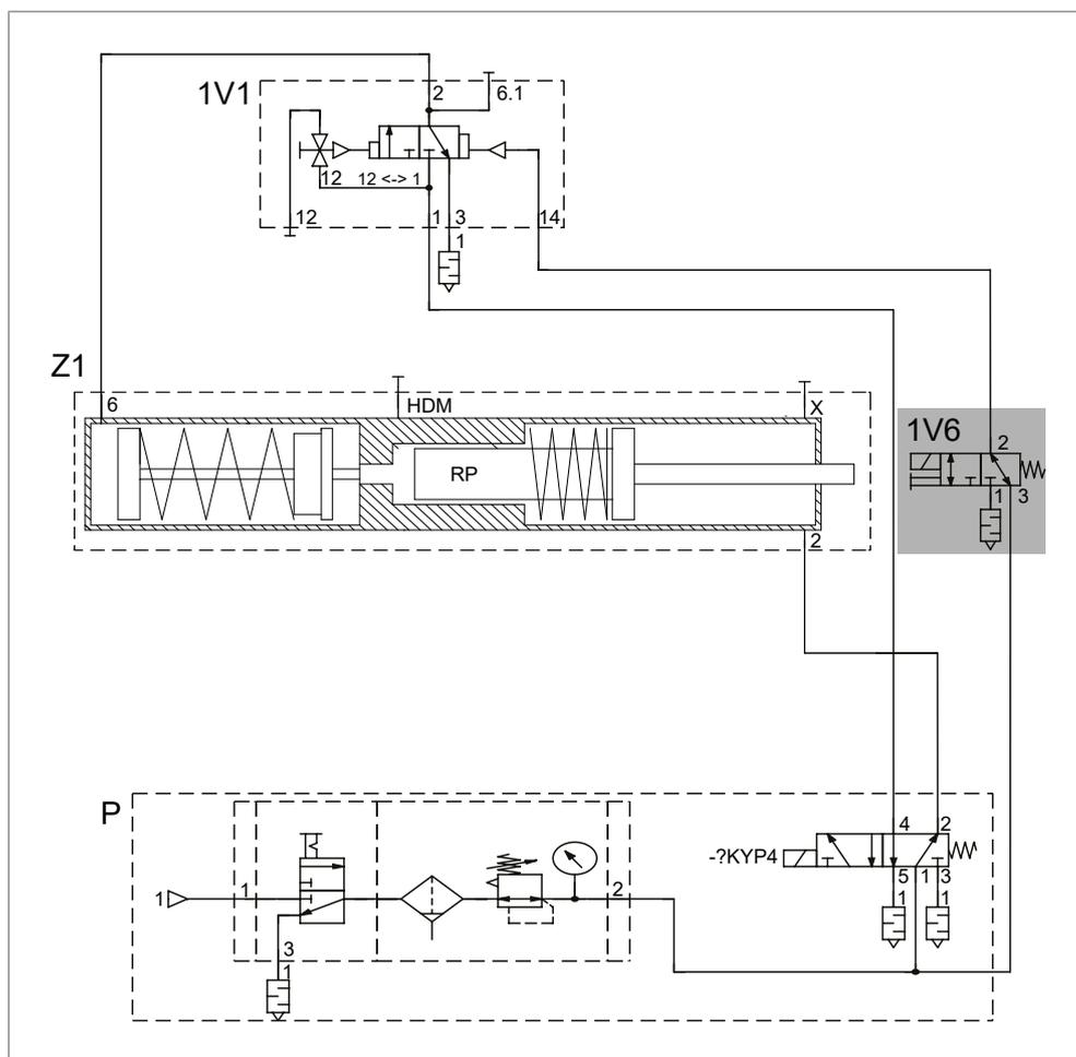
Fig. 15 Dispositif externe d'activation de la course de travail (module ZKHZ)
